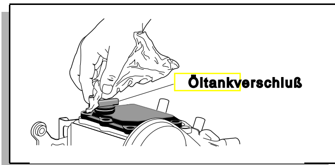
Abb. 25 Reinigung des Motoroberteils
